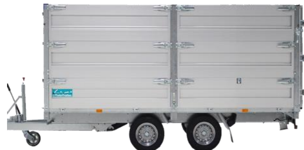
Seiten in 2 Teile mit ausnehmbare zentrale Runge **
