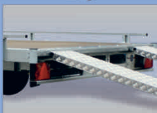
frei verschiebbare Auffahrschienen (Zubehör), passen sich jeder Spurbreite an
