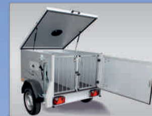
je Box eine separat nach außen zu öffnende Gittertür
