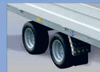
10"-Schwerlastbereifung für niedrige Auffahrhöhe
