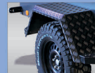
Offroad-Version: begehbare Kotflügel mit Trittleiste
