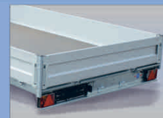
Klappe verhind. d. Herausrutschen d. unterschiedl. Auffahrschienen
