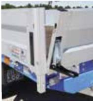
Der Anhänger hat vier steckbare **Aluminium-Eckungen**. Die nachstellbaren Verschlüsse lassen die Bordwände leicht verriegeln und sorgen für geräuscharme Fahrt. Aufbaumöglichkeit für Dachgestell und Aufsatz.
